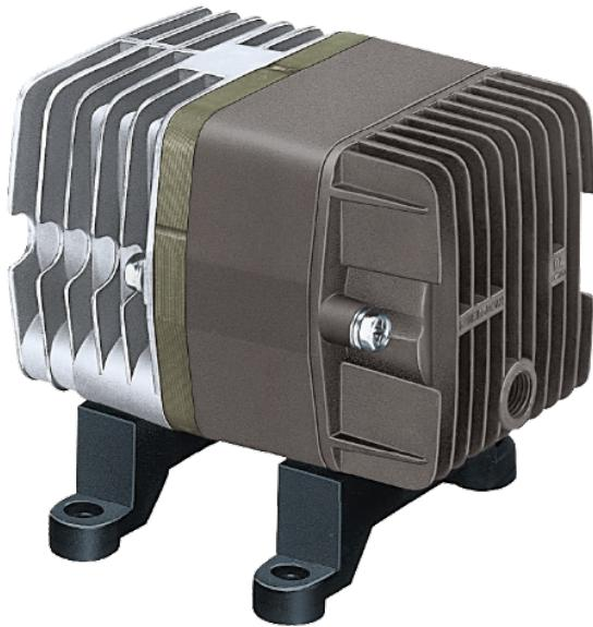
新型工业无油涡旋式空气压缩泵，包括电机部件和泵头部件，所述电机部件由电机外壳，电机定子，电机转子，主轴等组成，所述电机外壳内设置有电机定子，电机定子内设置有电机转子，电机转子中间插设有主轴，主轴通过轴承与电机外壳滚动连接后伸出电机部件，主机部件由机架，动盘，定盘组成，所述机架与电机外壳固定连接，机架远离电机外壳的一端固定连接有定盘，机架与定盘之间设置有动盘，动盘与定盘内镶嵌有偏心轴轴承，所述偏心轴轴承中间滚动连接有偏心轴，本发明压缩过程无油接触，动盘和定盘为非接触运行，运行时无金属摩擦，噪音小，弥补了涡旋机在工业领域的空白。压缩泵的接液部分根据介质不同选用碳钢保证了气液增压泵的性能
